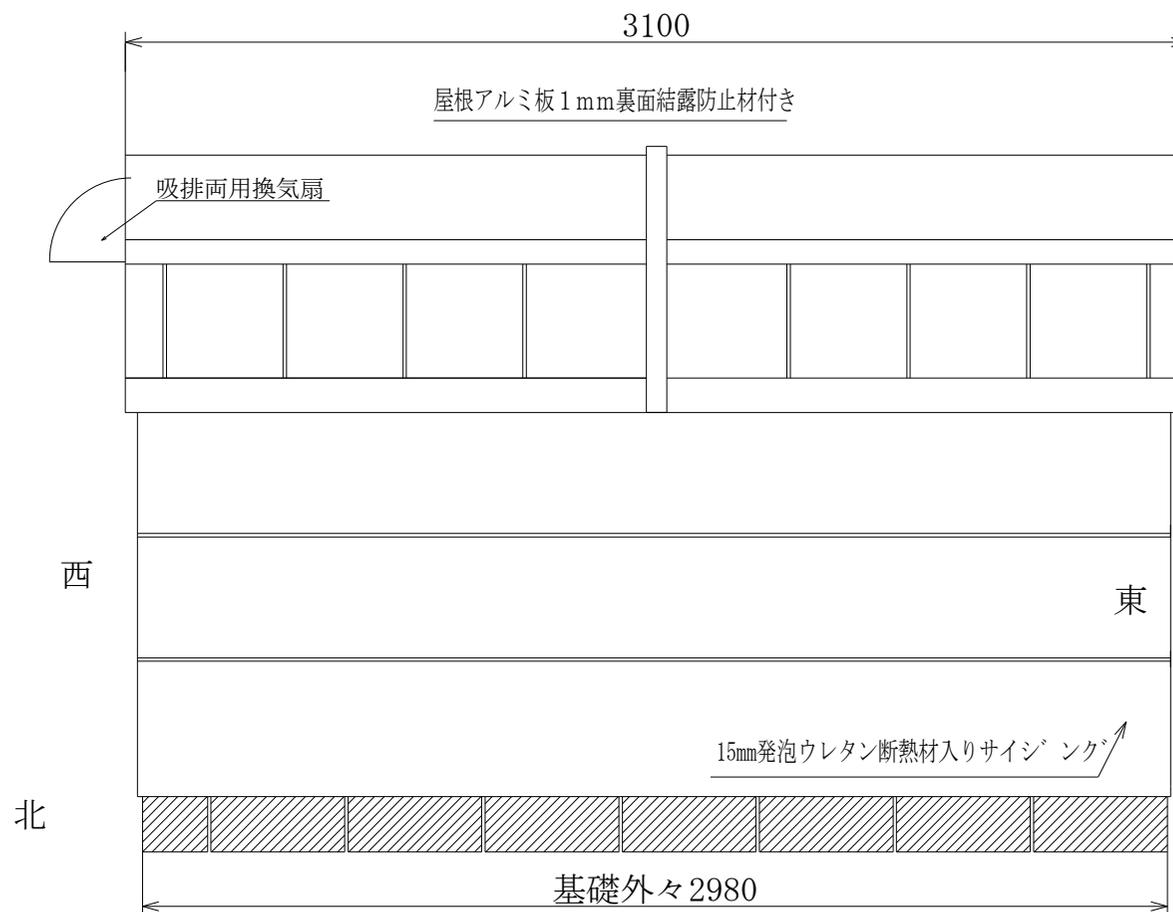
南側の可倒式防風板の関係がありますのでドアの取り付け位置（東西）を指定して下さい
