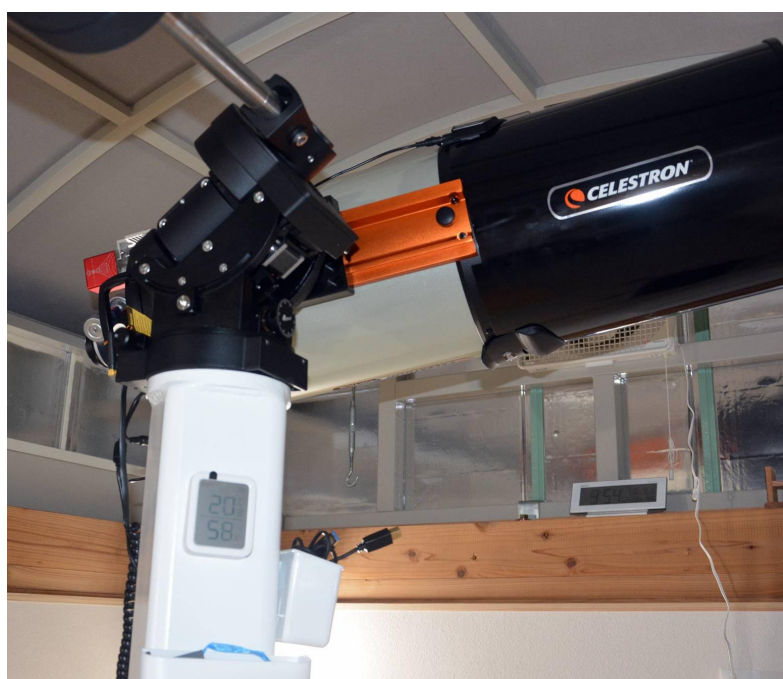
架台 ピラー接続状況
